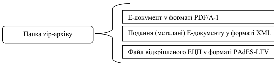
Рис. 2. Структура Е-документа згідно з чинним законодавством України для обміну між суб'єктами Е-економіки
